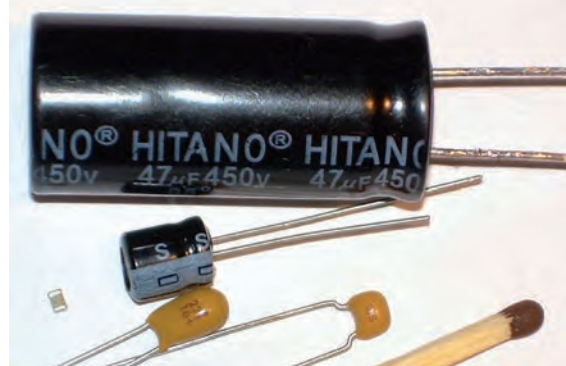
Fig. 1.35. La variedad de tamaños y tipos de condensadores es muy amplia.
