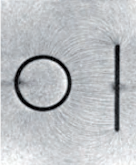
Fig. 1.27. Anillo y lámina, ambos conductores, con cargas eléctricas de diferentes signos. En el interior del anillo no hay líneas de campo, lo que indica que su intensidad es nula. Las líneas de campo son perpendiculares a las superficies de los conductores.
