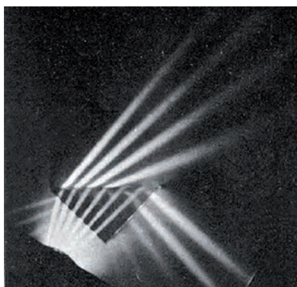
Fig. 4.12b. Haces luminosos procedentes de la izquierda que inciden en un prisma. Los dos del extremo derecho no dan lugar a haces refractados, sino solo reflejados, cuya intensidad aumenta.
