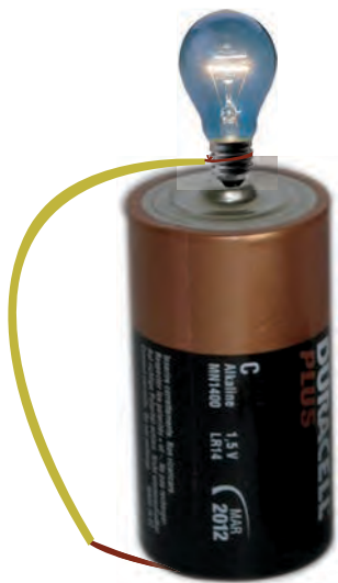
Fig. 2.8. Los electrones del alambre que conecta el bombillo a la pila se mueven desordenadamente con velocidades del orden de los 1 000 km/s, pero la velocidad del movimiento de conjunto de tales electrones es inferior a 0.07 mm/s.
