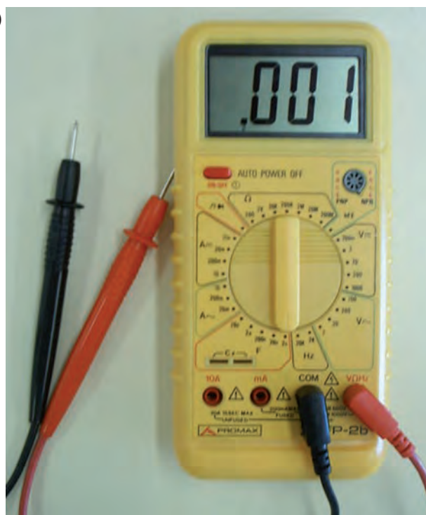
Fig. 2.10. (a) Microamperímetro analógico (de aguja). (b) Multímetro digital, utilizado para medir, entre otras magnitudes eléctricas, intensidad de corriente.
