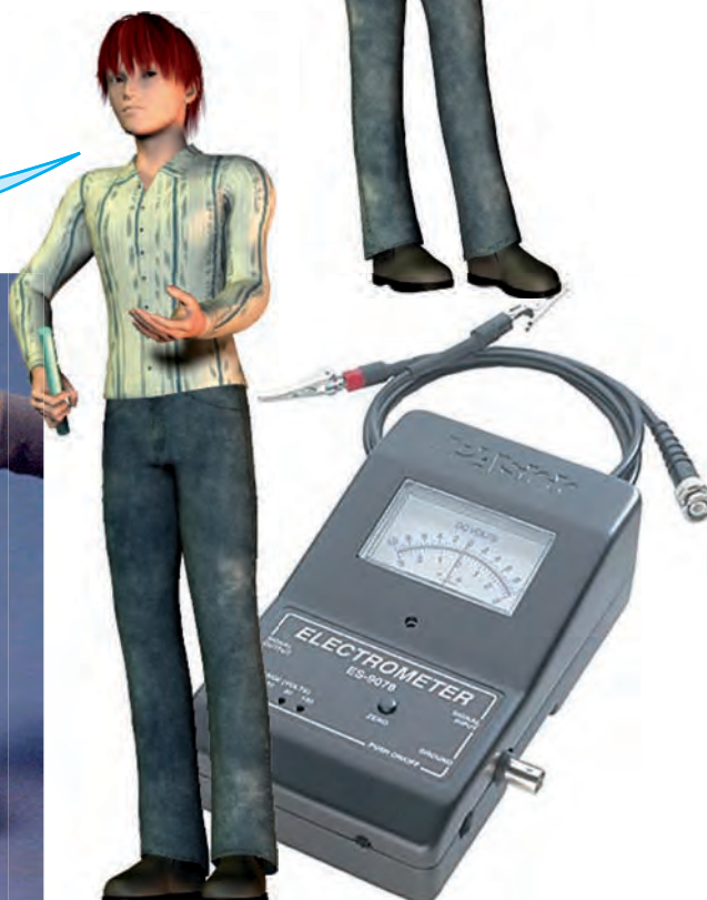
Fig. 1.13. Un electrómetro electrónico digital, es similar a un voltímetro, pero posee una elevadísima resistencia de entrada, del orden de 10^{12} ohm, característica que lo encarece.
