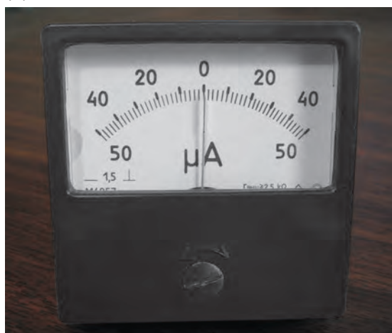
Fig. 2.10. (a) Microamperímetro analógico (de aguja). (b) Multímetro digital, utilizado para medir, entre otras magnitudes eléctricas, intensidad de corriente.
