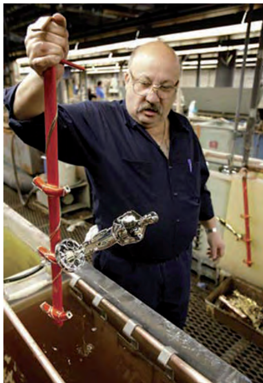
Fig. 2.21. Recubrimiento de cuerpos con una capa de metal mediante electrólisis.
