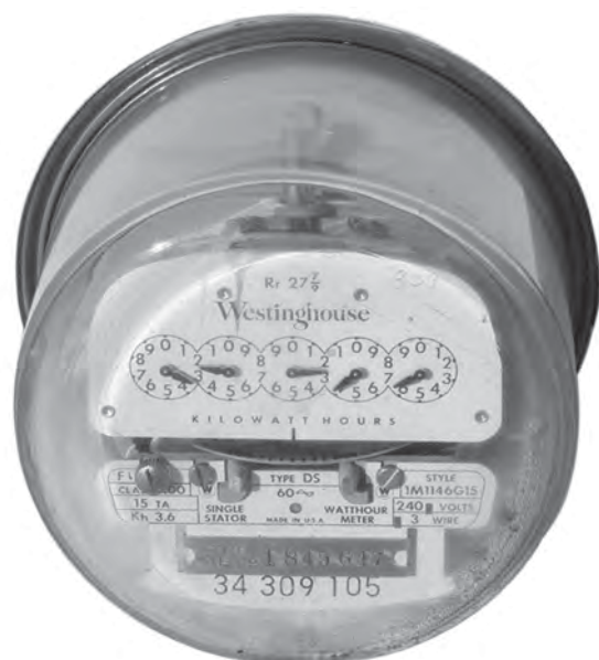
Fig. 2.41. Medidor de consumo eléctrico electromecánico.
