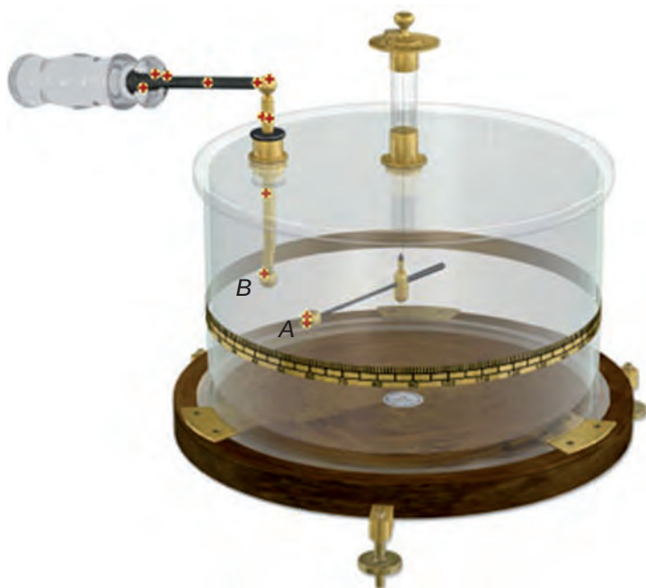
Fig. 1.16. Esquema del dispositivo utilizado por Coulomb para establecer la ley de la fuerza de interacción entre dos partículas cargadas.
