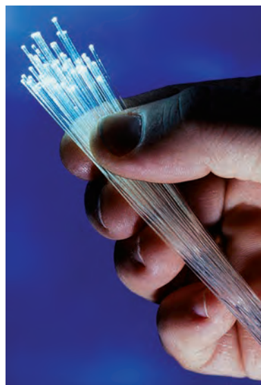
Fig. 4.14. El diámetro de una fibra óptica habitual es similar al de un cabello humano.
