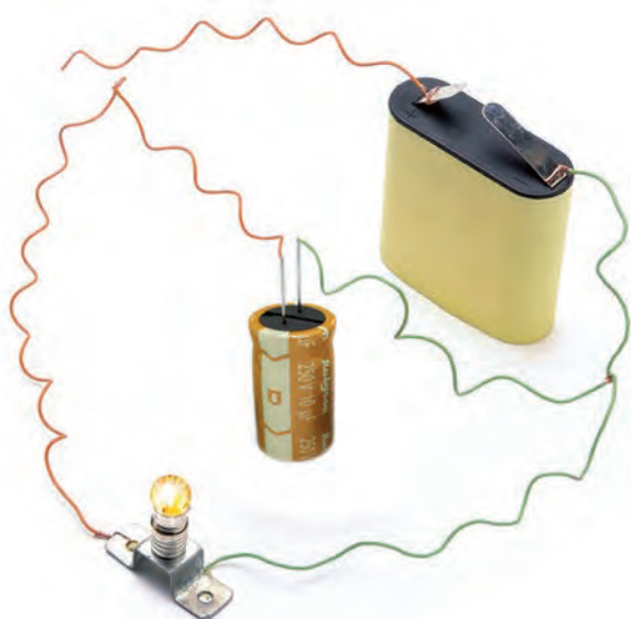
Fig. 1.36. Si se carga un condensador conectándolo a una batería y luego se desconecta de ella y se conecta a un bombillo de pequeño voltaje, éste se enciende por un instante, lo que evidencia que el condensador posee energía.
